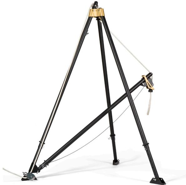
Das BOMBTEC HAL Dreibein-Modul (Schwerlast) bietet dem EOD-Techniker eine bessere Kontrolle beim Anheben und Herausziehen verdächtiger Gegenstände. Dieses innovative Dreibein-Stativ benötigt nur eine einzige Leine, um das Zielobjekt anzuheben und um anschließend einen klappbaren Lastarm auszulösen, der das Zielobjekt außerhalb des Stativs positioniert.
