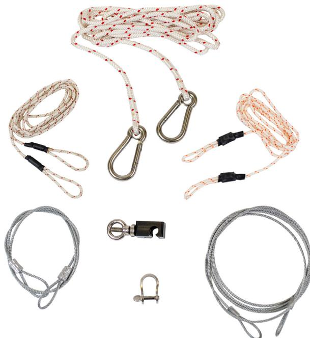
Das BOMBTEC HAL Seilschlingen-Modul dient zwei zentralen HAL-Funktionen: „Befestigung und Verankerung“. Die Seilschlingen sind aus vorgedehntem Polyesterseil gefertigt und verfügen an beiden Enden über 35mm flexible Ösen. Jedes Ende ist zusätzlich mit gecrimpten Aluminiumpleißen gesichert. Die Drahtschlingen bestehen ebenfalls aus verzinktem Stahldraht. Auch hier befindet sich an beiden Schlingenenden eine 30mm flexible Öse, die mit gecrimpten Aluminiumpleißen gesichert ist.
