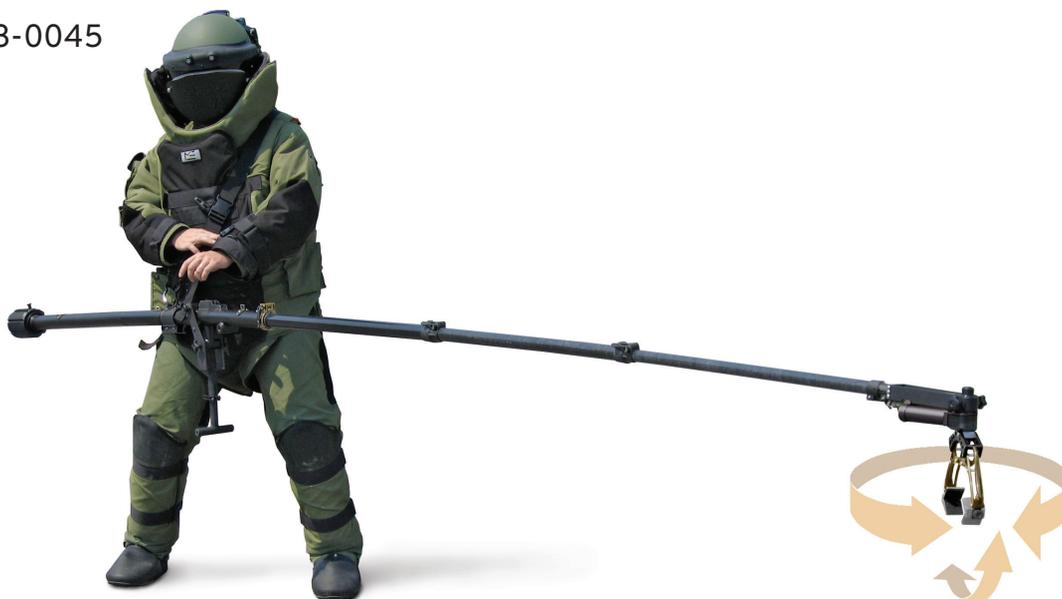
Der TM 600 Teleskopmanipulator bietet EOD-Technikern die Möglichkeit, einen größeren Abstand zwischen sich und einer explosiven Bedrohung zu bringen. Der Teleskop-Arm lässt eine Entfernung bis 3 m zu. Ein einstellbares Gegengewicht und ein Schultergurt unterstützen den Anwender beim effektiven Einsatz des Geräts.
