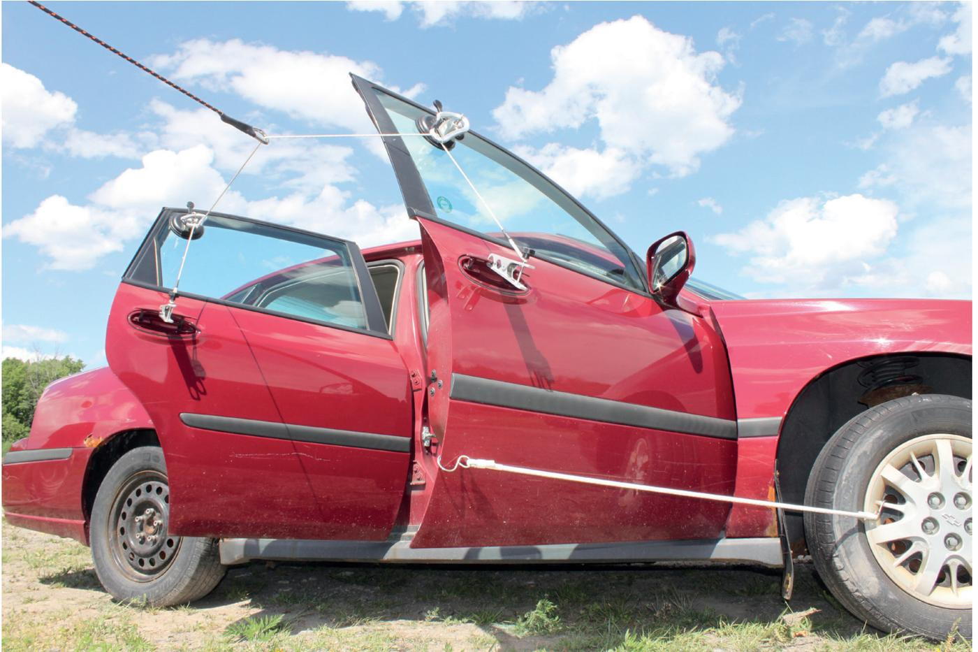
Das Med-Eng BOMBTEC HAL System überzeugt durch eine große Auswahl an vielfältig verwendbaren Haken- und Leinensätzen- und -Modulen. Jede dieser Komponenten wurde für unterschiedliche Anwendungssituationen entwickelt.
